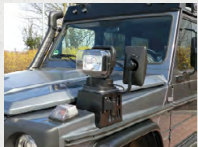
ORC Mercedes G - Suchscheinwerfer Mit Funkfernbedienung. Vertikal und horizontal 360° schwenkbar, kann fest verschraubt oder auf Magnetplatte abnehmbar verwendet werden. Preis auf Anfrage
