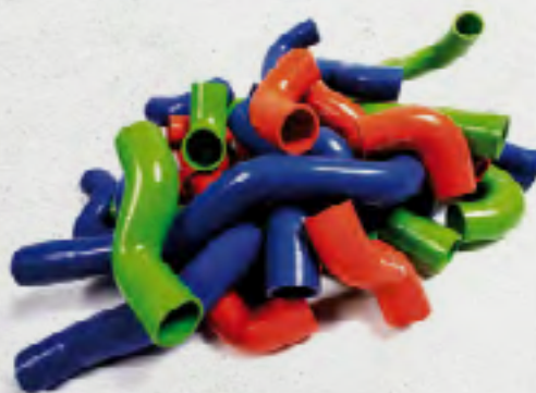
Silikon Ladeluftschläuche Silikon Turboschläuche sind speziell ausgelegt für Turbolader- und Ansaugsysteme. Sie werden aus mehrlagigem Silicon mit Polyester-Verstärkung gefertigt und halten Betriebstemperaturen von -50 °C bis 180 °C stand.
